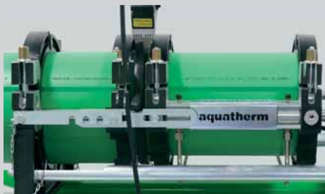
Postavljanje grijaćeg elementa
