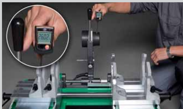
Mjerenje temperature na aquatherm stroju za zavarivanje
