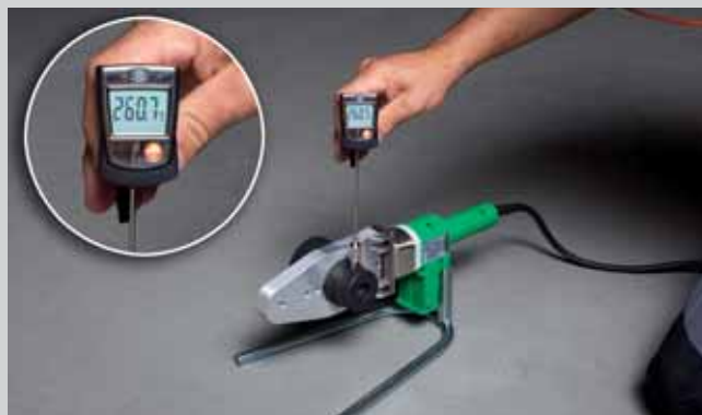
Mjerenje temperature na aquatherm aparatu za ručno zavarivanje (800 W)
