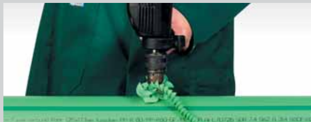
Bušenje stijenke cijevi
