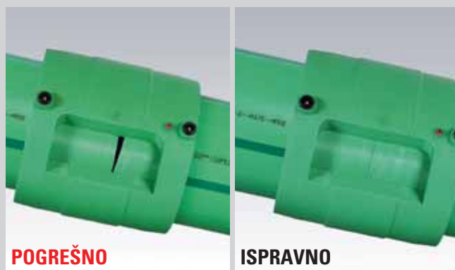
Za optimalan, stabilan rezultat zavarivanja preporučamo da se oba kraja cijevi unutar E-spojnice polože međusobno planparalelno! Obavezno poštivati minimalne dubine zavarivanja!
