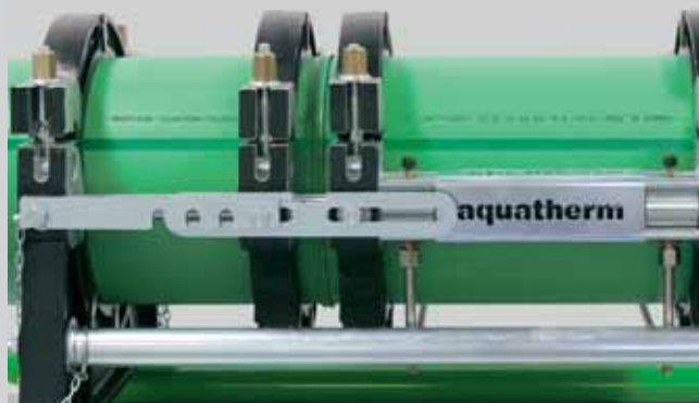
Spojite cijevi, pustite da se hlade pod pritiskom
