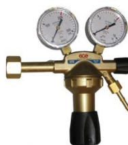
Man. lijevo = tlak u boci Man. desno = radni tlak O_2 na plameniku
