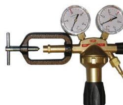
Man. lijevo = tlak u boci Man. desno = radni tlak C_2H_2 na plameniku
