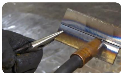
Ručni elektrolučni postupak, s automatskom dobavom dodatnog materijala, u zaštitnoj atmosferi inertnog plina MIG postupak.
